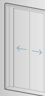
CENTER - OPENING Cửa mở tự động từ tâm
